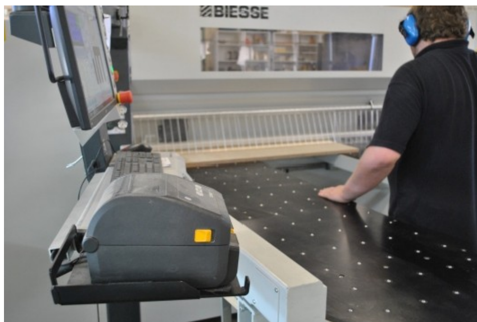
De platen worden doorgaans op eindformaat gebracht aan de linkerzijde van de opdeelzaag
