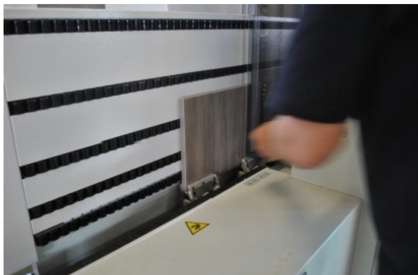
De verticale CNC kan zowel links als rechts in- en uitgeladen worden
